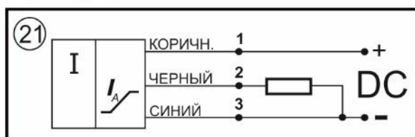
Схема соединения пропорциональный ток на выходе
